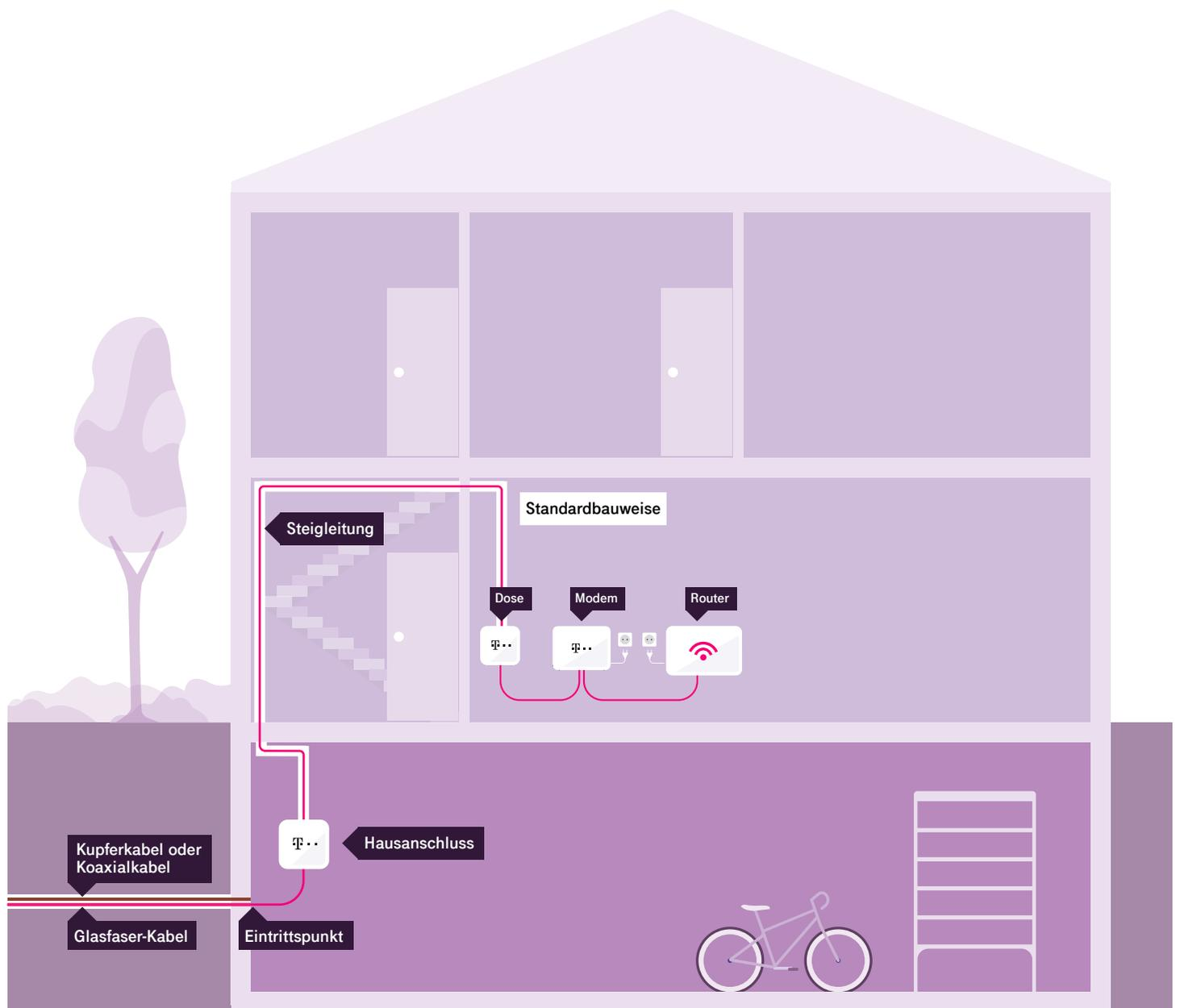
In Mehrfamilienhäusern liegt der Eintrittspunkt in der Regel im Hausanschlussraum. Von dort aus wird das Glasfaser-Kabel über die einzelnen Etagen in die Wohnungen verlegt. Der Wohnungseintritt erfolgt in der Regel über das Treppenhaus. Wir montieren Ihre Glasfaser-Dose im Umkreis von 3 Metern des Wohnungseintritts. Dort können Sie Ihr Glasfaser-Modem anschließen und mit Ihrem Router verbinden.
