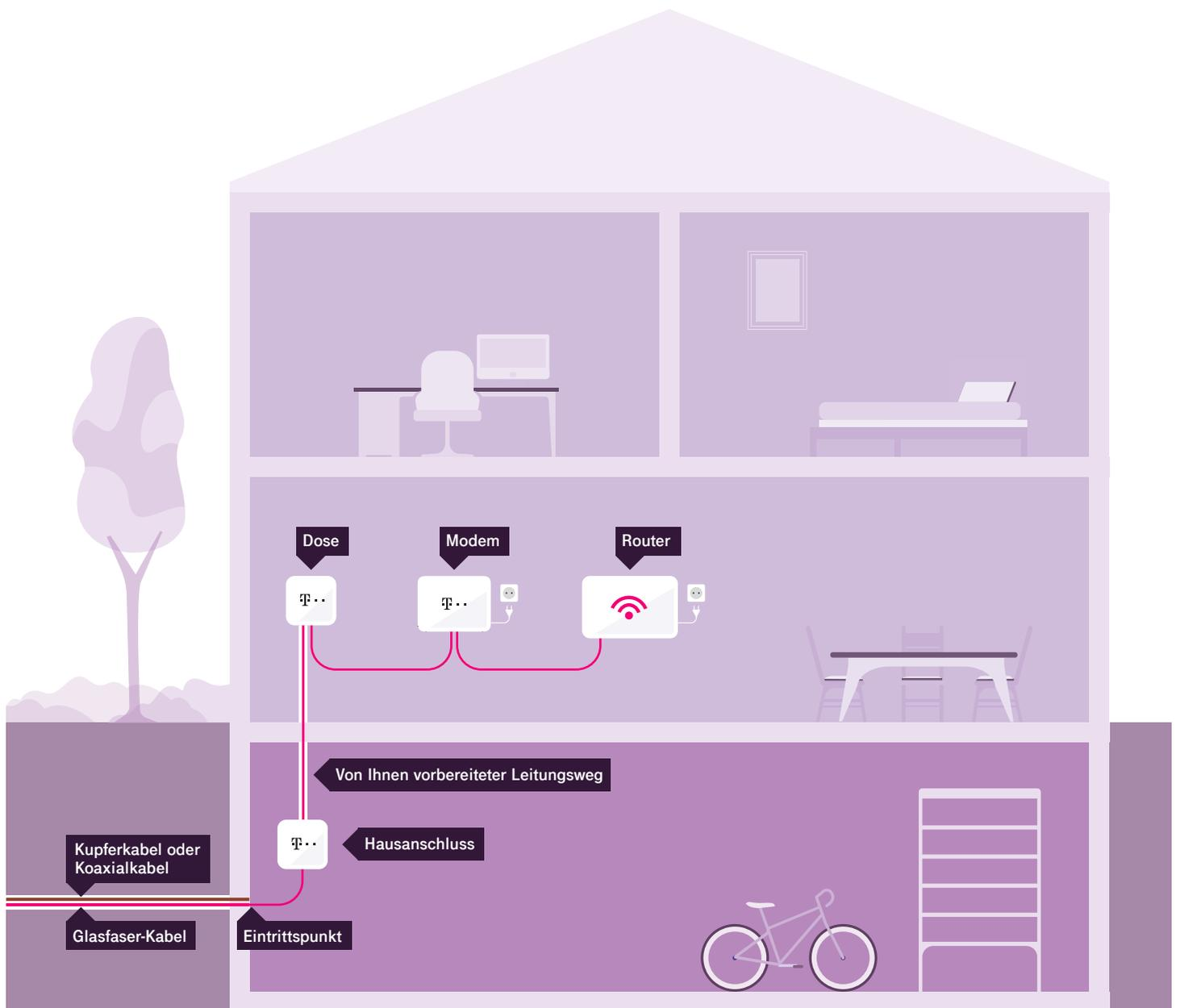
Wenn Sie einen Leitungsweg mit Kabelkanälen und ggf. erforderlichen Decken- bzw. Wanddurchbrüchen vorbereitet haben, verlegen wir Ihnen während des Verkabelungstermins kostenlos bis zu 20 Meter Glasfaser-Kabel. Außerdem montieren wir die Glasfaser-Dose an Ihrem Wunschort. Im Abschnitt „Leitungsweg vorbereiten“ zeigen wir Ihnen, wie Sie den Leitungsweg vorbereiten können.
